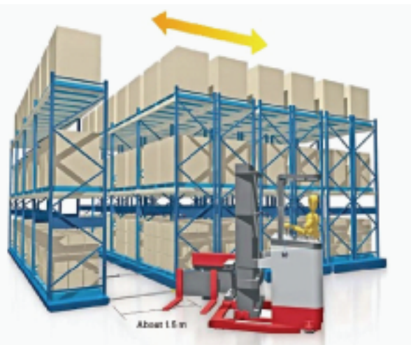
在1.6米的导轨通道,货位架通道在1.8米的通道内进行作业
